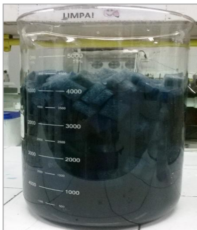
Figura 8- Teste de adsorção do corante na EPU utilizada como meio suporte.
