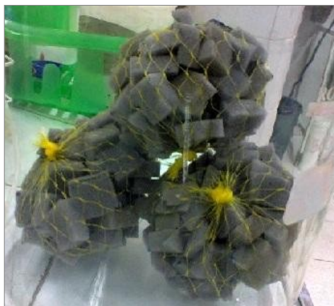
Figura 6 – Distribuição das EPU em redes de polietileno no RBS.
