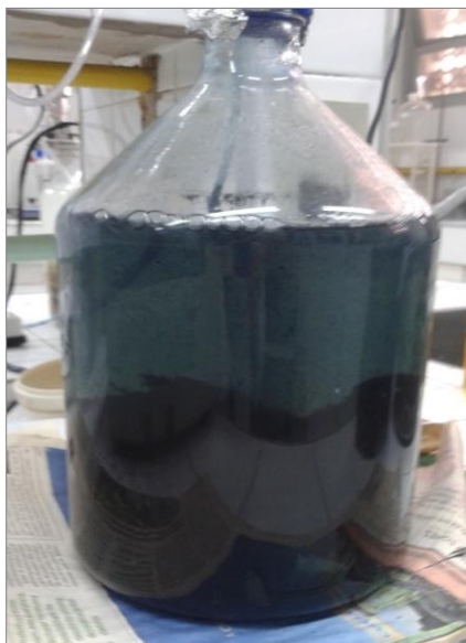
Figura 7 - Reator aeróbio em bateladas sequenciais com biomassa imobilizada.
