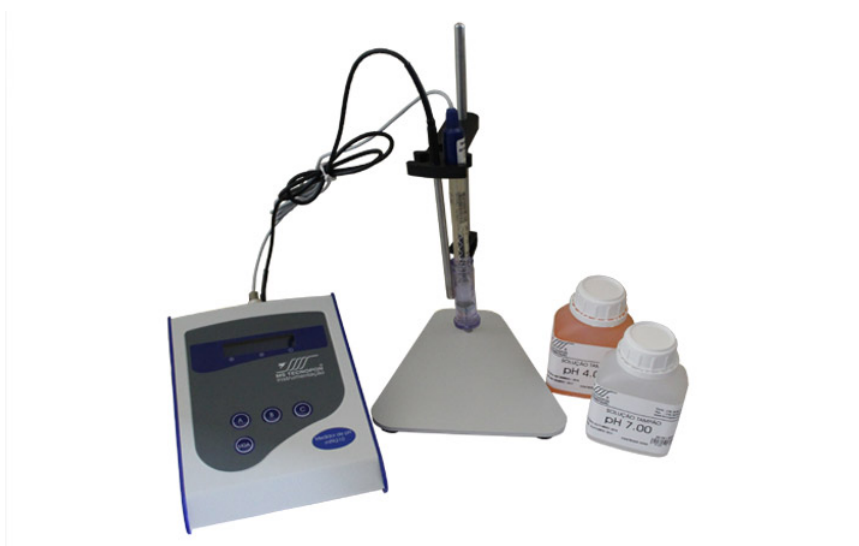
Figura 38: Medidor de pH de referência da Tecnopon ® , modelo mPA-210.
