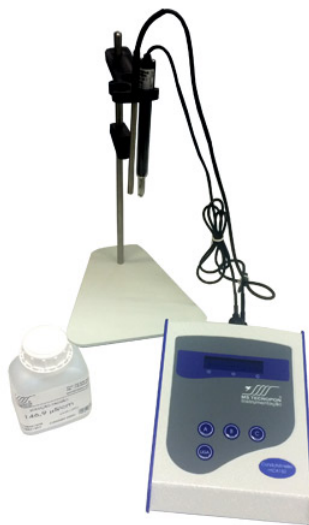
Figura 37: Condutivímetro de referência da Tecnopon ® , modelo mCA-150.
