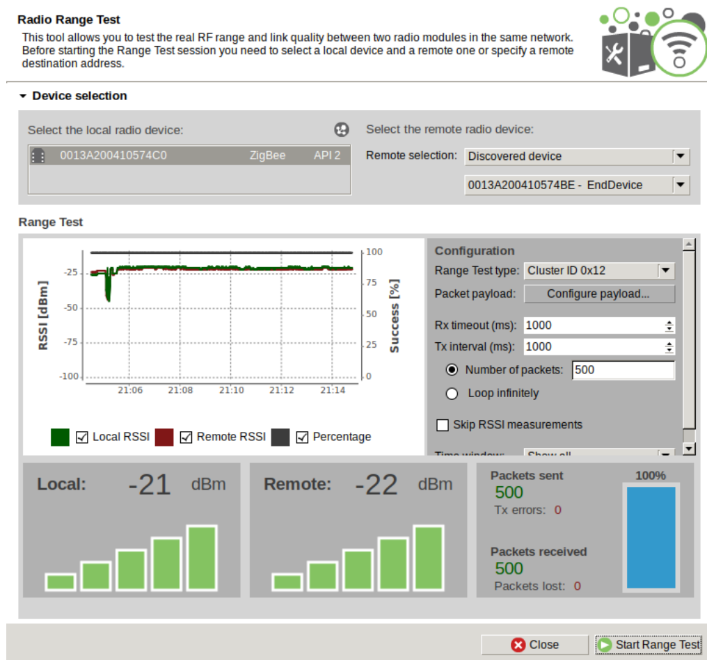
Figura 32: Exemplo de teste de alcance utilizando software XCTU® .
