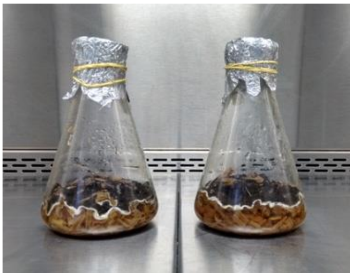
Figura 7 - Crescimento micelial fúngico no bagaço de cana: à esquerda, sem glicose presente e à direita, com glicose.
