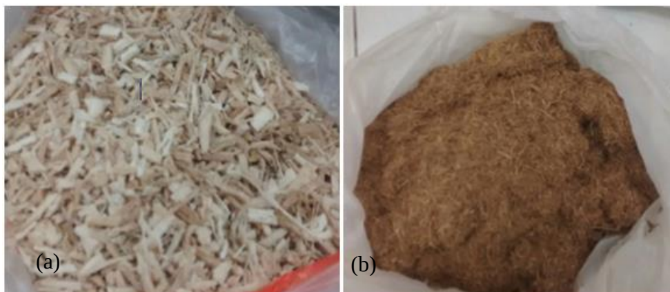
Figura 4 - Substratos bagaço de cana-de-açúcar (a) e casca de coco (b) para produção de celulasas por Aspergillus niger AN400.
