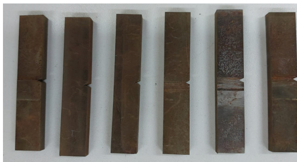
Figura 31 – Corpos de Prova Ensaio Charpy das amostras não tratadas.
