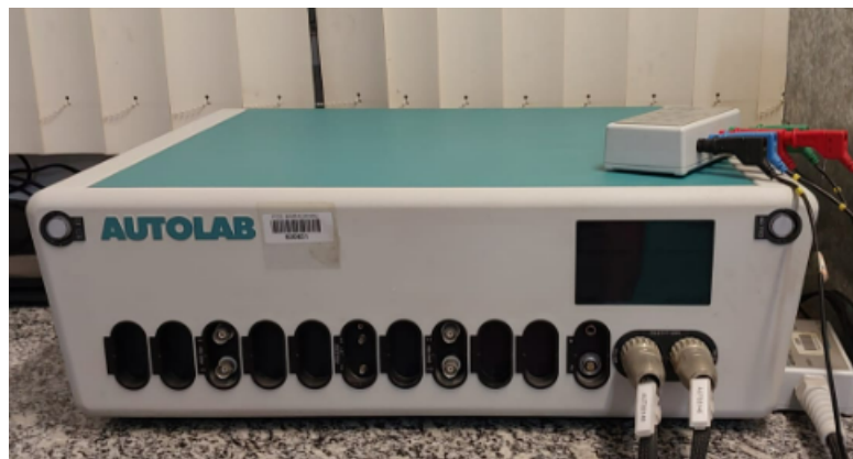
Figura 34 – Bancada de testes para os ensaios eletroquímicos: Autolab PGSTAT 128N.
