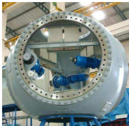
Figura 8 – Cubo (Hub) do Aerogerador.
