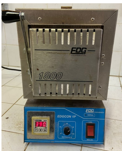
Figura 24 – Forno EDG utilizado no tratamento térmico.
