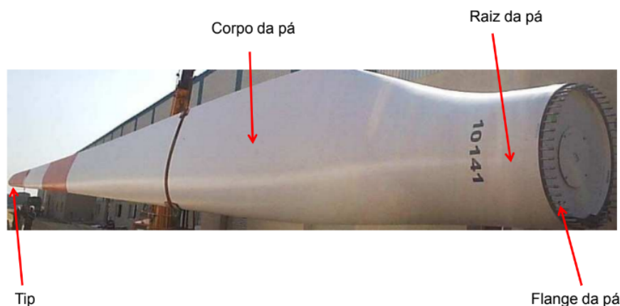
Figura 6 – Componentes da Pá Eólica.
