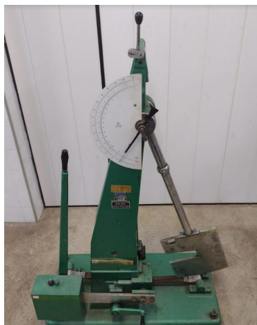
Figura 29 – Máquina de ensaio Charpy.
