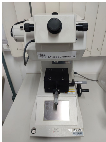
Figura 25 – Microdurômetro utilizado neste trabalho.
