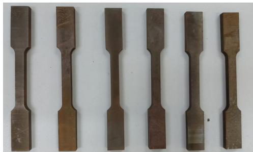
Figura 27 – Corpos de Prova Ensaio Tração.
