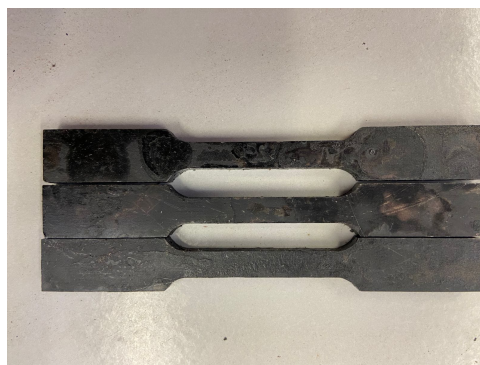
Figura 28 – Corpos de Prova Ensaio Tração Tratados Termicamente.
