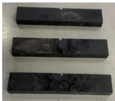
Figura 32 – Corpos de Prova Ensaio Charpy das amostras tratadas termicamente.
