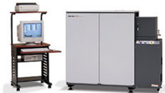
Figura 23 – Espectrômetro de Emissão Óptica utilizado neste trabalho.
