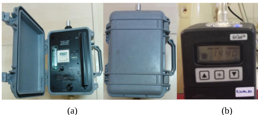
Figura 3 – Sistema de amostragem de material particulado MiniVol da AirMetrics® (a) e Bomba AirCheck XR5000 da SKC (b).
