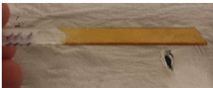
Figura 23 – Substrato de sílica com filme fino
