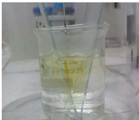
Figura 22 – Tratamento do substrato de sílica com ácido nítrico
