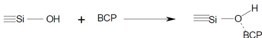
Figura 17 – BCP integrado à rede de sílica pela ação do SDS
