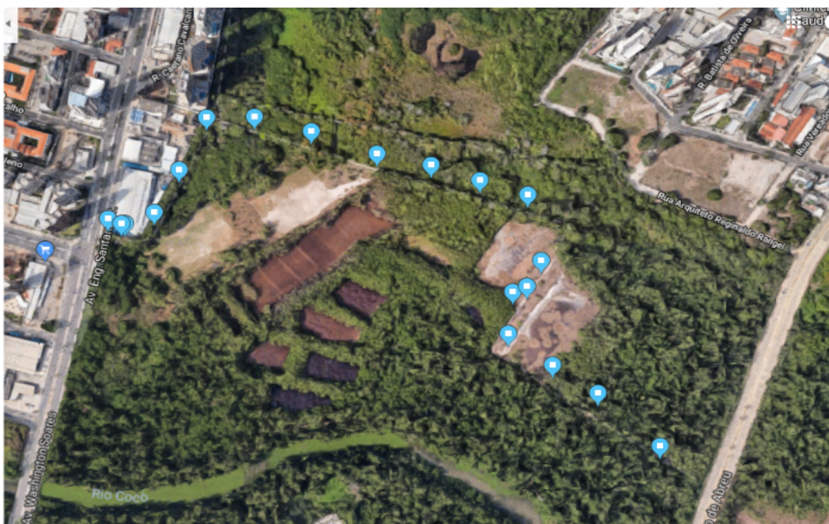
Figura 34: Ilustração dos pontos que marcam cada roteador utilizado para cobrir a trilha do parque do Cocó. Fonte: O autor, 2018
