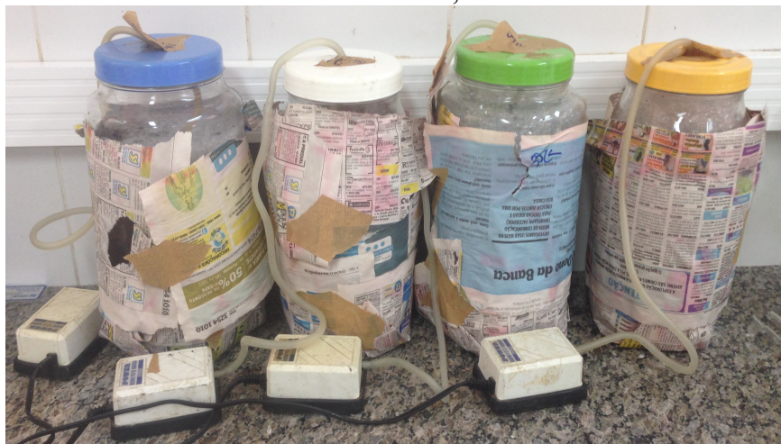
Figura 16 - Reatores de vidro com volume útil de 2,5 L utilizados nos ensaios.
