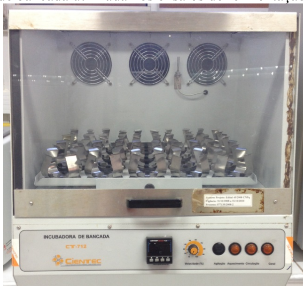
Figura 19 - Incubadora de bancada utilizada nos ensaios de fermentação submersa.
