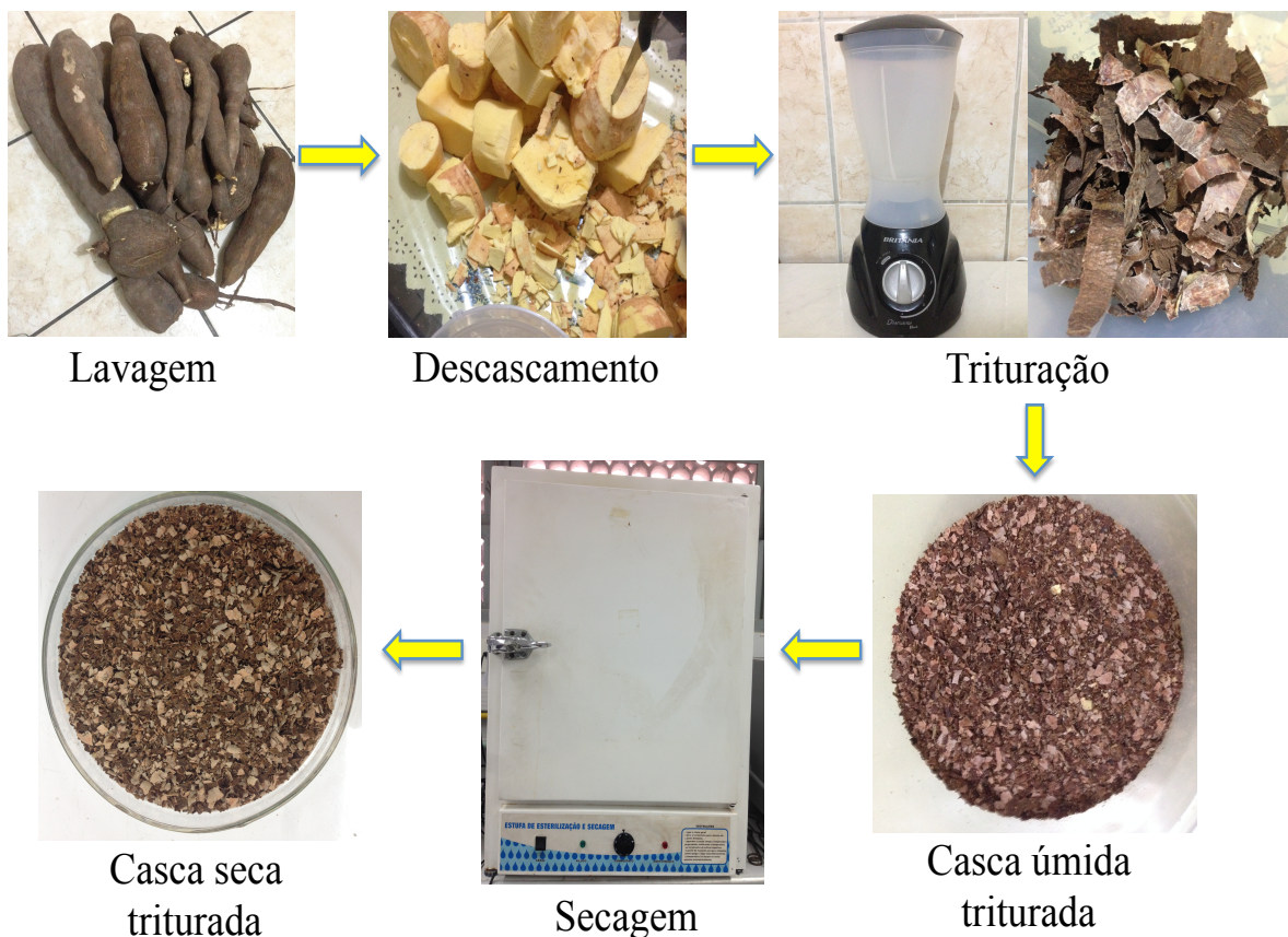
Figura 15 - Fluxograma da preparação da casca de mandioca para utilização nos ensaios de biodegradação de PQT e produção da enzima celulase.
