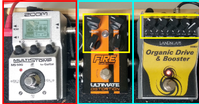
Figura 4 – Da esquerda para direita, unidades de efeito analógicas (sob caixas azuis) e unidade multiefeitos digital (sob caixa vermelha). Parâmetros das unidades sob caixas amarelas. A unidade multiefeitos possui diversos potenciômetros e botões para ajustar os parâmetros dos efeitos aplicados sob o sinal.
