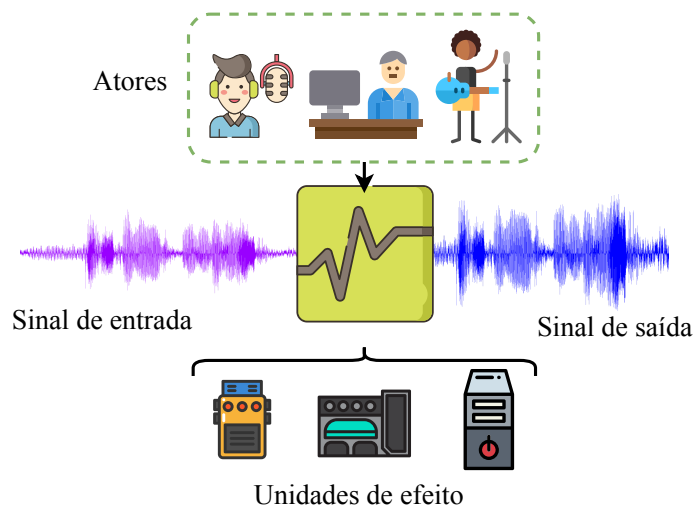
Figura 2 – Uma unidade de efeito aplica um ou mais efeitos de áudio sobre um sinal de entrada. Um efeito aplicado possui parâmetros, os quais são ajustados por atores do processo de produção musical. Ícones feitos por Freepik, itim2101, Flat Icons, xnimrodx e smalllikeart de <www.flaticon.com>.
