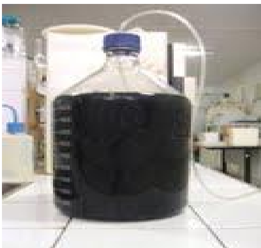
Figura 8 - Ilustração do reator biológico em bateladas sequencias com biomassa imobilizada de Aspergillus niger AN 400 preenchido com água residuária industrial têxtil diluída a 10% (v/v).
