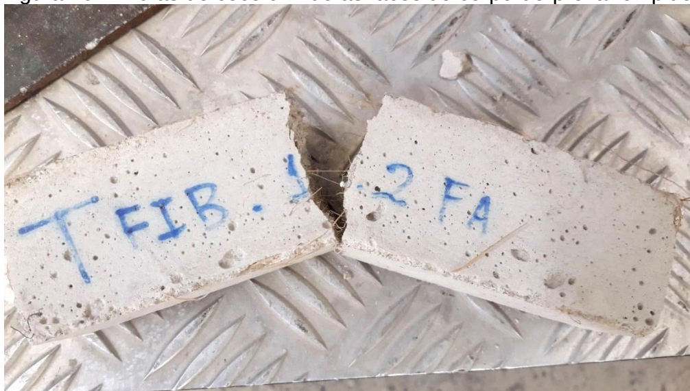
Figura 16 – Fibras do coco unindo as faces de corpo-de-prova rompido
