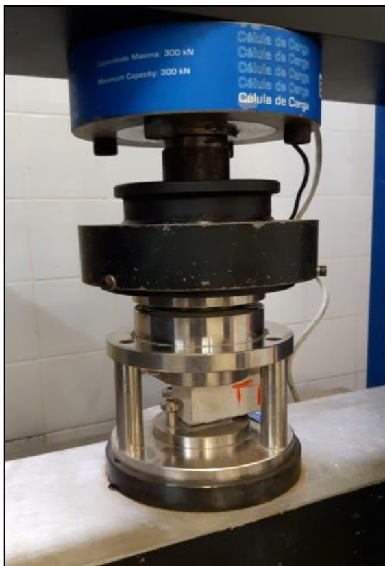
Figura 14 – Ensaio de Resistência à compressão e corpo-de-prova após ensaio
