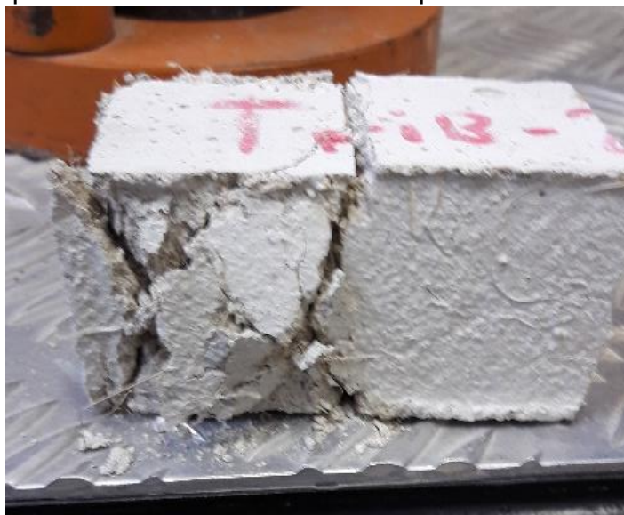
Figura 17 – Corpo-de-prova com fibras do coco após ensaio de resistência à compressão
