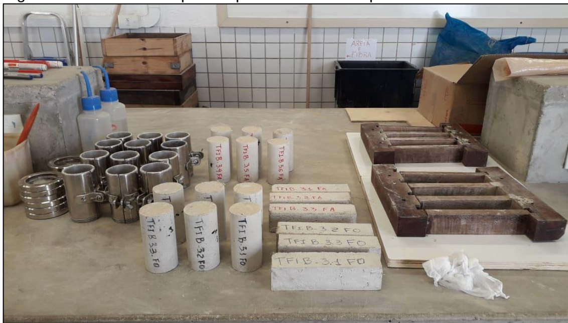
Figura 10 – Moldes e corpos-de-prova cilíndricos e prismáticos
