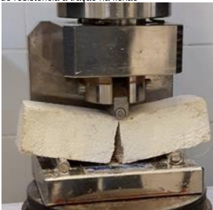
Figura 15 – Ruptura do corpo-de-prova em ensaio de resistência à tração na flexão
