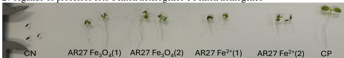
Figura 24 — Crescimento radicular nos ensaios de ecotoxicidade para as soluções de Acid Red 27 segundo os processos foto-Fenton heterogêneo e Fenton homogêneo
