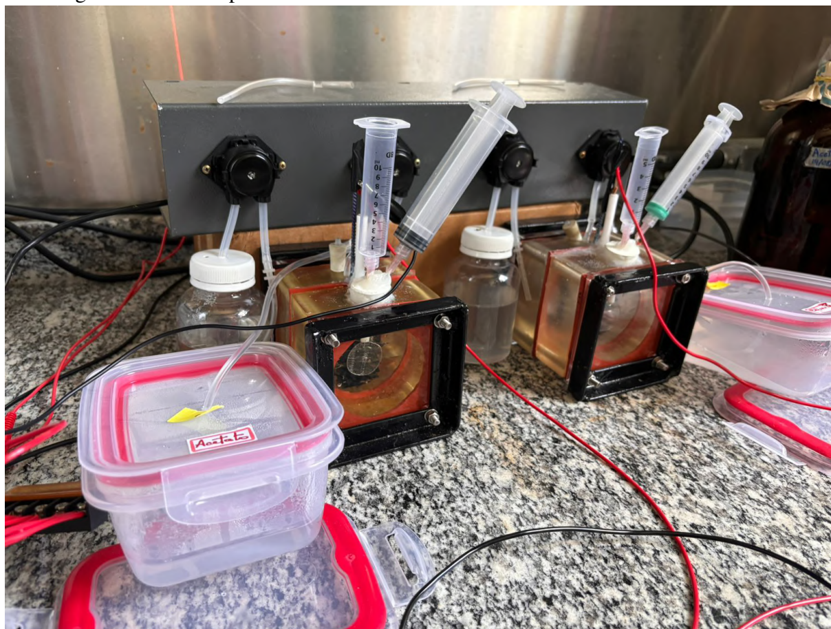
Figura 27 – Protótipos de Célula de Eletrólise Microbiana
