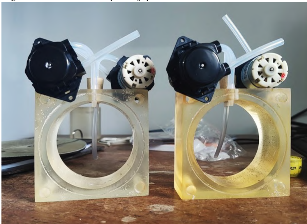
Figura 19 – Bombas de Sucção e Injeção na Câmara Anódica
