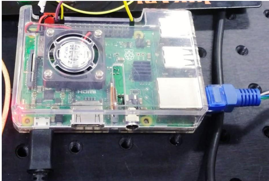
Figura 19: Foto da Raspberry Pi 3B durante os testes em laboratório.
