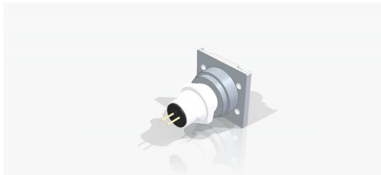
Figura 12: Modelagem acoplador LED/fibra no Solid Edge.
