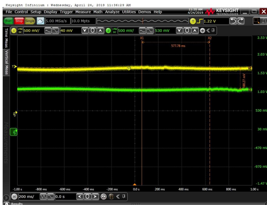
Figura 47. Variação da amplitude do sinal em cada uma das fibras vistas pelo osciloscópio durante o terceiro teste.
