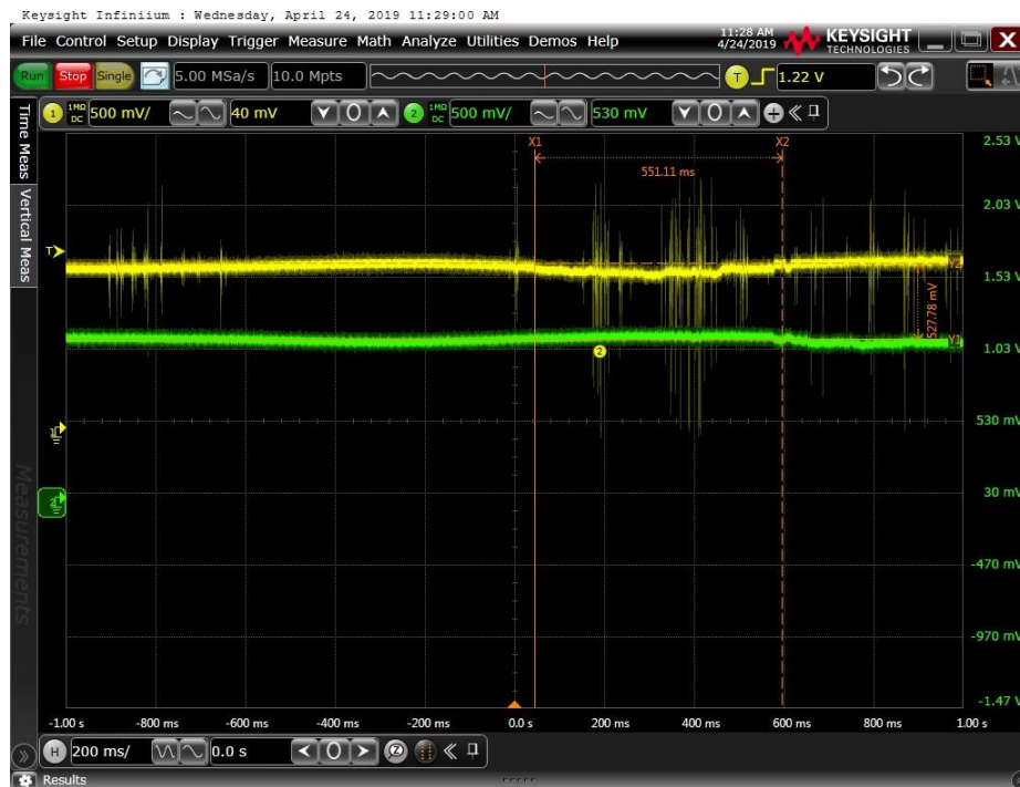
Figura 46. Variação da amplitude do sinal em cada uma das fibras vistas pelo osciloscópio durante o segundo teste.
