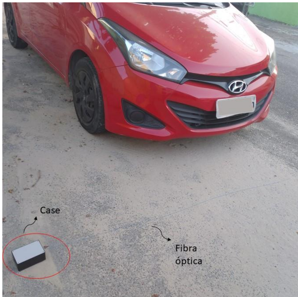
Figura 30. Carro na área de sensoriamento durante os testes em campo.
