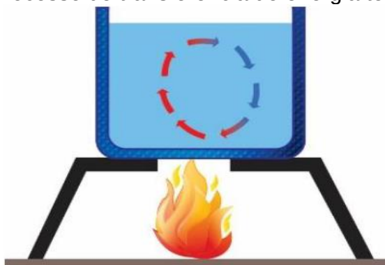
Figura 8 – Processo de transferência de energia térmica por convecção
