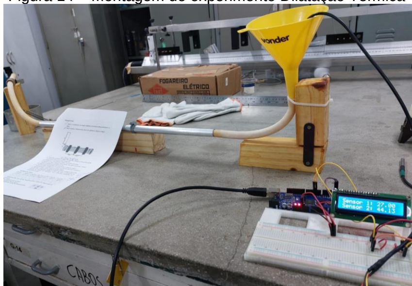
Figura 14 – Montagem do experimento Dilatação Térmica
