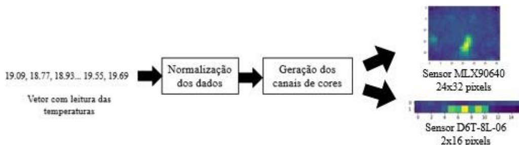
Figura 15 - Processo para gerar as imagens extraídas dos sensores
