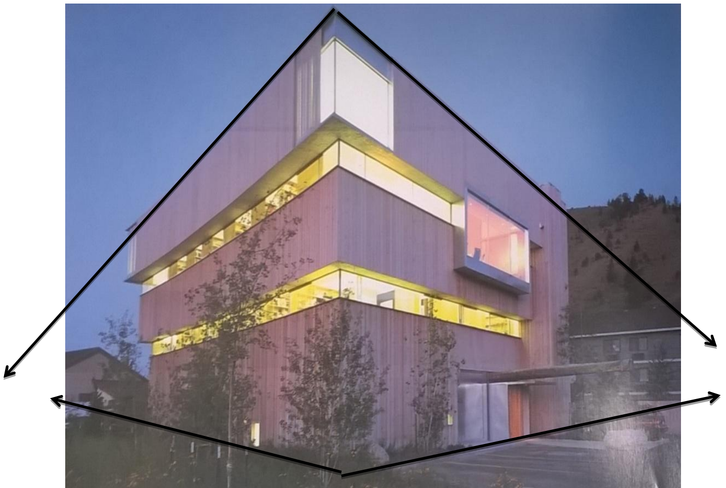
Figura 35 – Foto de uma edificação representando uma perspectiva oblíqua. As linhas convergentes migram para dois pontos de fuga, um do lado direito e o outro do lado esquerdo do edifício.
