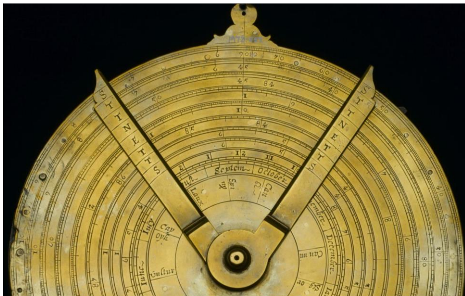
Figura 20 – Os indicadores dos círculos de proporção.
