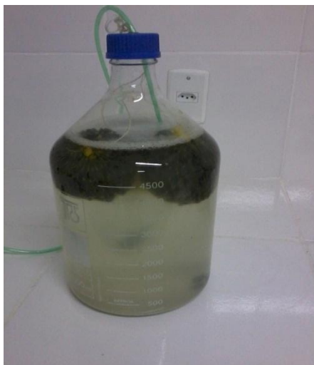
Figura 04 - Reator em batelada sequencial utilizando biomassa imobilizada de Aspergillus niger AN 400
