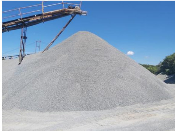
Figura 11 — Pilha de brita 3/8" - OCS
