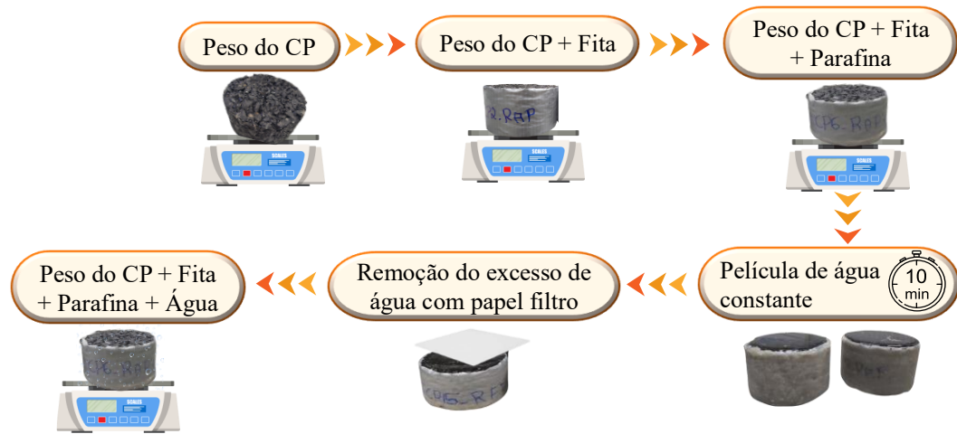
Figura 25 — Procedimento do ensaio de vazios comunicantes
