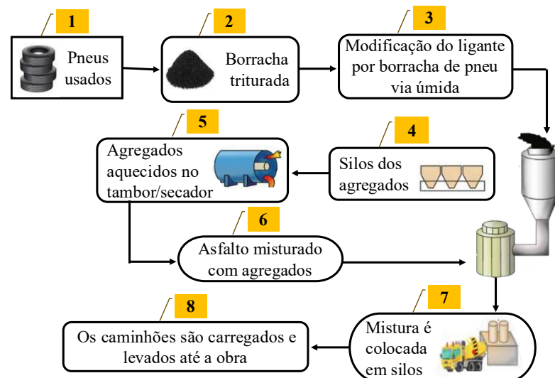
Figura 9 — Esquema de fabricação do AB via úmido pelo processo de mistura estocável
