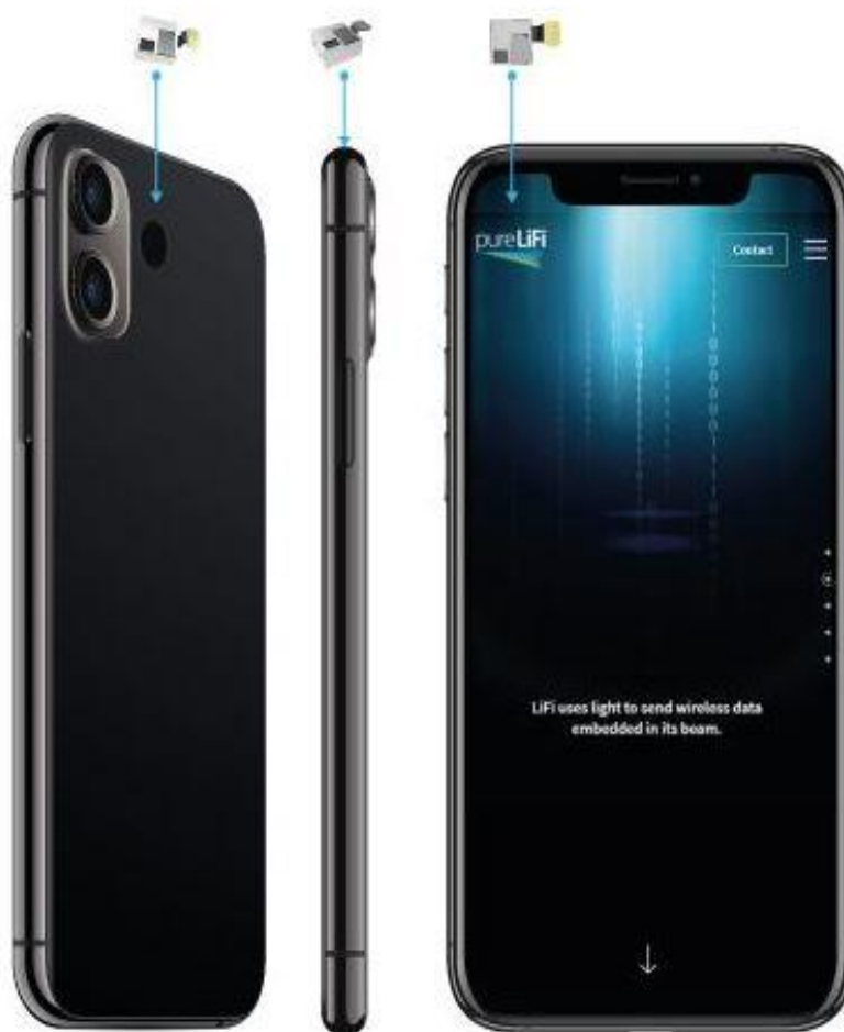
Figura 7 – Antena óptica para integração dispositivos móveis
