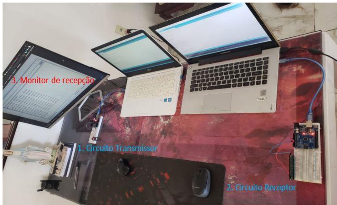
Figura 24 – Circuitos Transmissor e Receptor de Strings entre Arduinos
