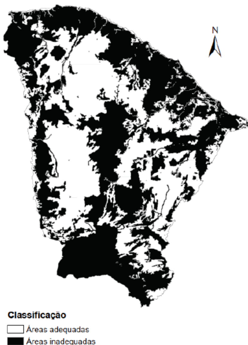
Figura 5: Áreas disponíveis para a instalação de energia fotovoltaica em grande escala
