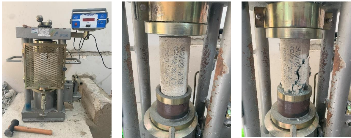
Figura 19 – Ensaio de resistência à compressão do concreto
