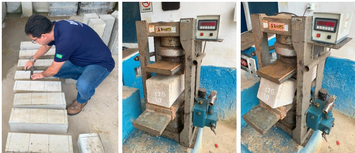
Figura 20 – Ensaio de resistência à tração na flexão do concreto
