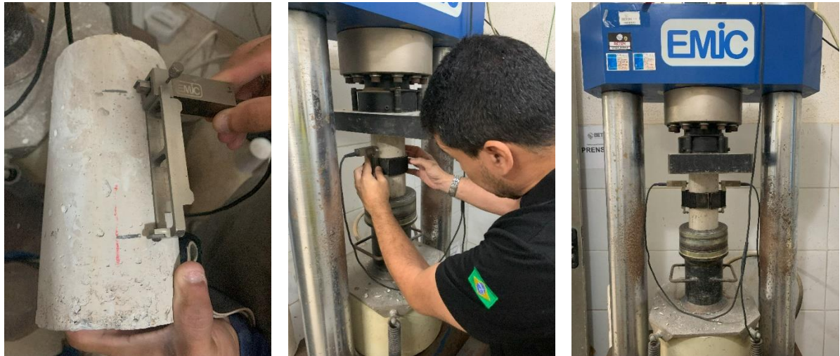
Figura 21 – Ensaio de determinação do módulo de elasticidade
