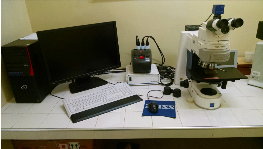
Figura 5.2: Microscópio ótico com aquisição digital de imagens da marca Zeiss
