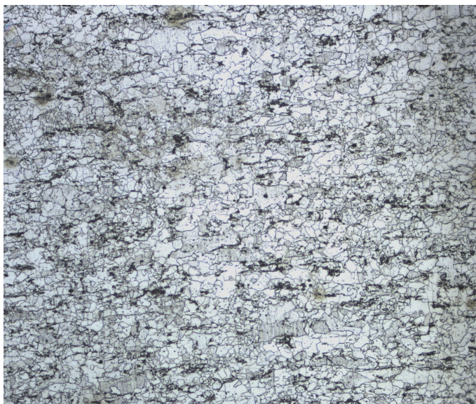
Figura 6.1: Fotomicrografia de amostra da classe 0 - AE-50%-620°-1min
