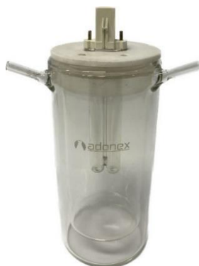
Figura 4 — Reator de quartzo utilizado nos experimentos de degradação fotocatalítica.
