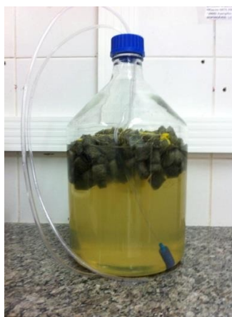
Figura 7 – Imobilização da biomassa fúngica de Aspergillus niger AN 400 em cubos de poliuretano.
