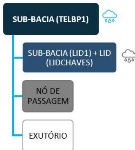
Figura 7 – Fluxo de escoamento na sub-bacia antes e depois da aplicação LID
