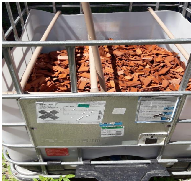
Figura 18 — Camada de fragmentos de tijolos como parte do substrato no wetland construído.
