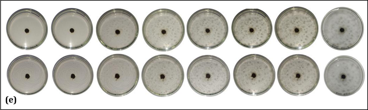
Figura A2 — Crescimento de placas controle de crescimento isolado das colônias de A. niger ao longo de 7 dias no meio ASW CAG 5 – Controle (a), 5 ‰ (b), 10‰ (c), 20‰ (d), 30‰ (e).
