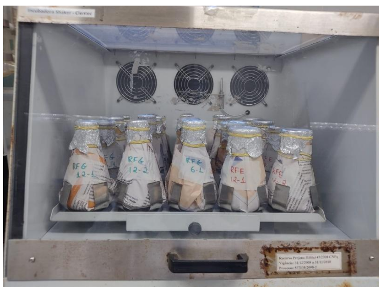
Figura 6 — Reatores em agitação na incubadora de bancada (shake).
