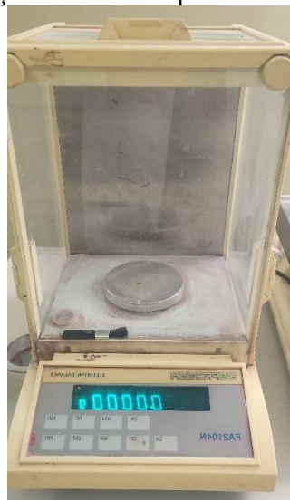
Figura 7 — Balança analítica Bioprecisa modelo FA2104N.
