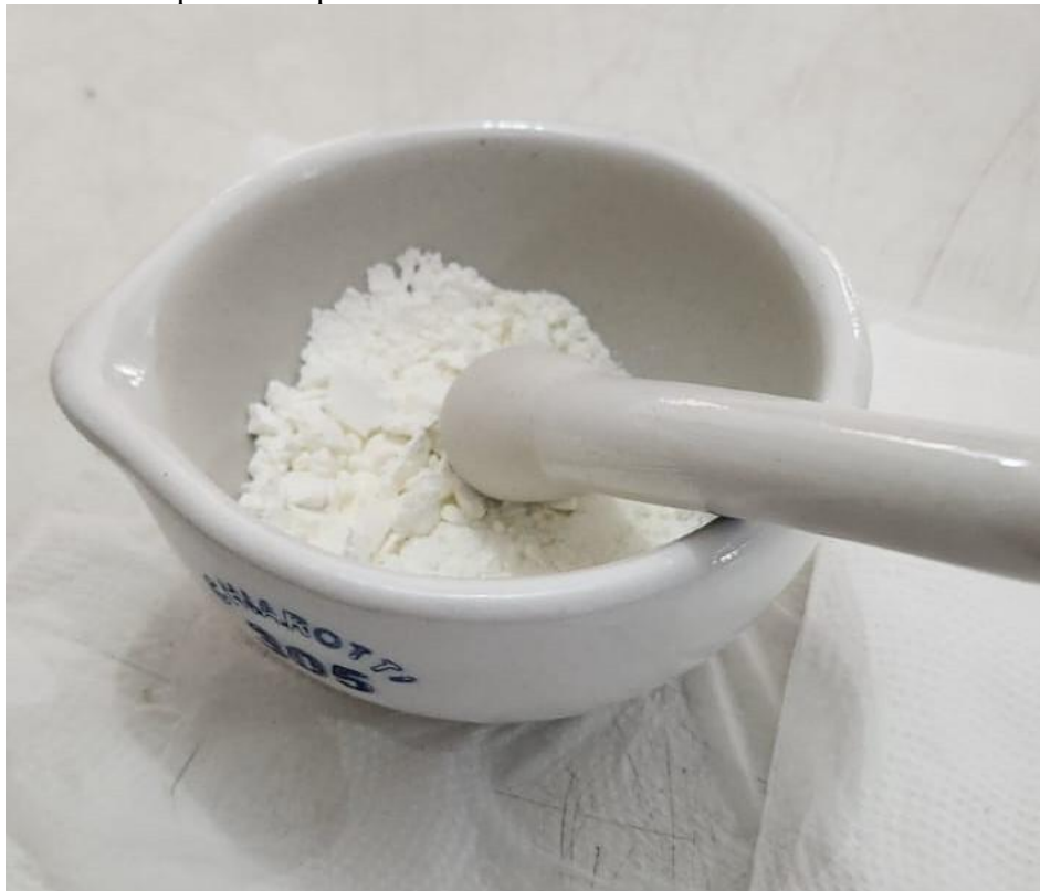
Figura 13 — Etapa de homogeneização das fases \text{LaNbO}_4 e \text{Bi}_2\text{O}_3 usando almofariz e pistilo de porcelana.
