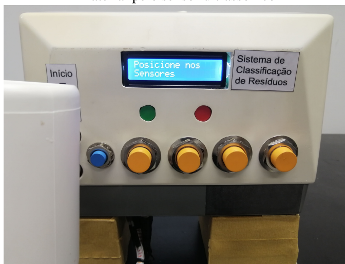
Figura 16 – Painel de classificação após a identificação do material pelo sensor ultrassônico
