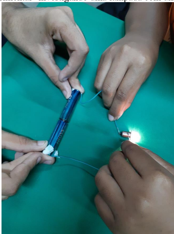
Figura 15 - Prática experimental “investigando uma lâmpada com uma pilha”
