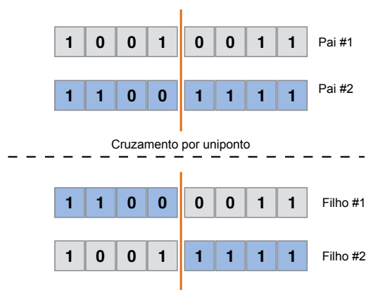
Figura 22: Cruzamento pelo operador uniponto.
