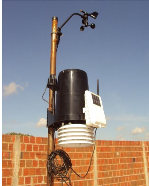
Figura 11 - Estação meteorológica automática, Estação Meteorológica Automática do IFCE - Fortaleza (LERCA)
