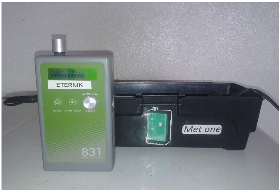
Figura 13 - Met One 831: medidor de partículas MP_1 ; MP_{2,5} ; MP_4 e MP_{10}
