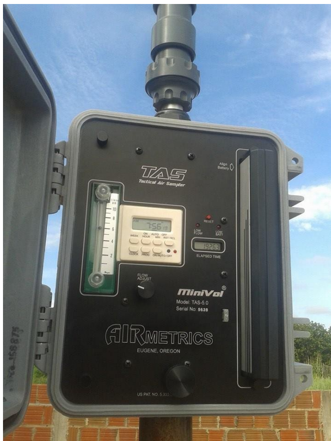
Figura 14 - Mini Vol TAS: Medidor de Partículas MP 2,5
