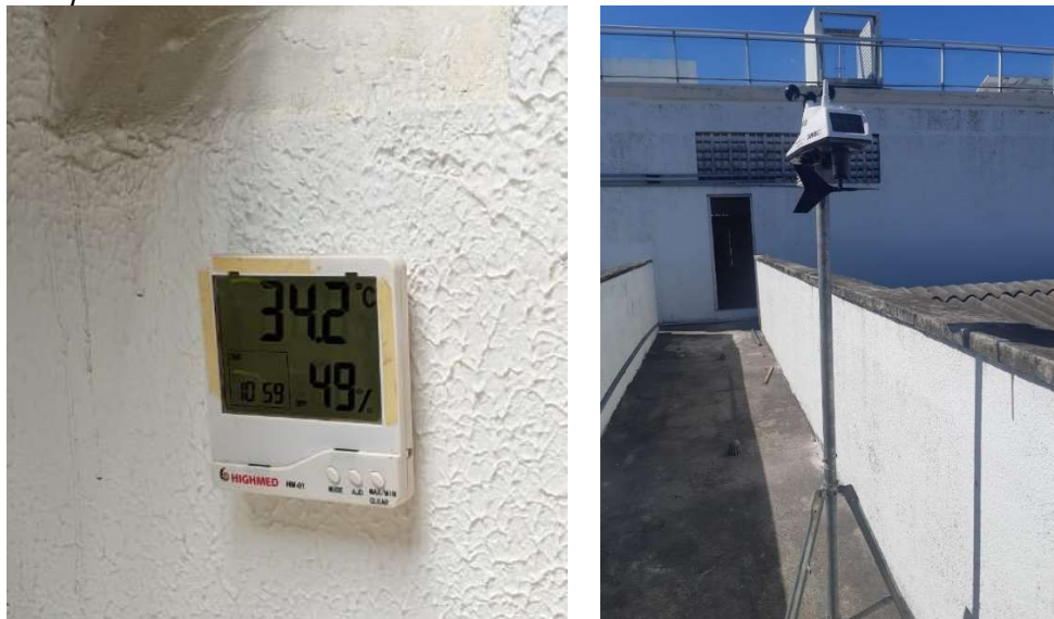
Figura 17 — Equipamentos para monitoramento da temperatura e umidade relativa do ar. a) Termo-higrômetro instalado no ambiente de operação da pesquisa; b) Estação Meteorológica Vantage Vue Davis instalada na cobertura do Bloco Didático, localizada no Instituto Federal do Ceará, Campus Fortaleza
