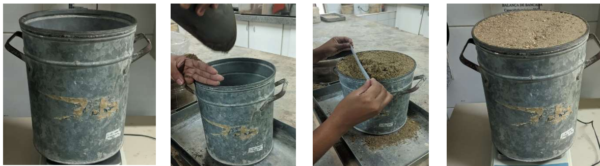
Figura 12 — Procedimento do ensaio de massa unitária da areia em estado solto
