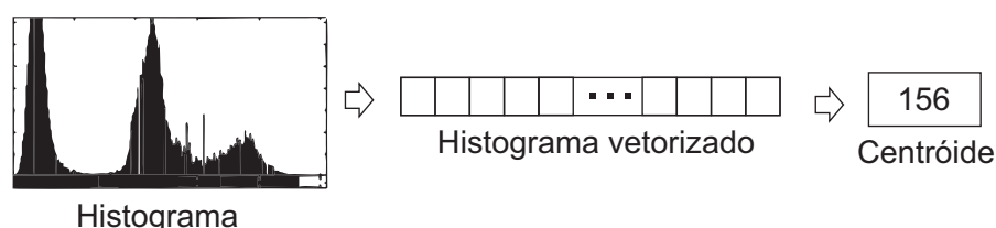
Figura 49: Cálculo do centróide de uma banda qualquer de uma imagem colorida.
