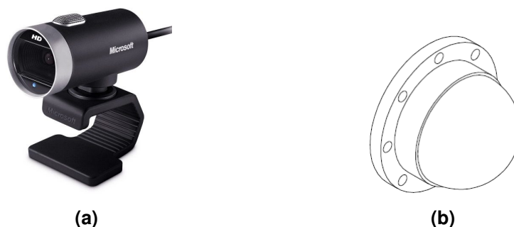
Figura 47: Sistema catadióptrico: (a) câmera utilizada e (b) geometria do espelho usinado.
