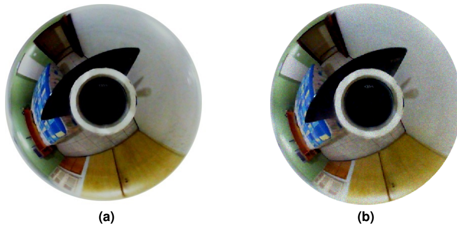
Figura 55: Novas imagens de teste: (a) imagem com iluminação alterada e (b) imagem com iluminação alterada e submetida a ruído com variância igual a 0,02.
