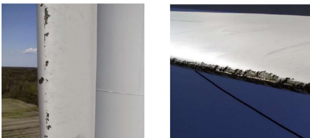
Figura 7 – Exemplos de danos de erosão
