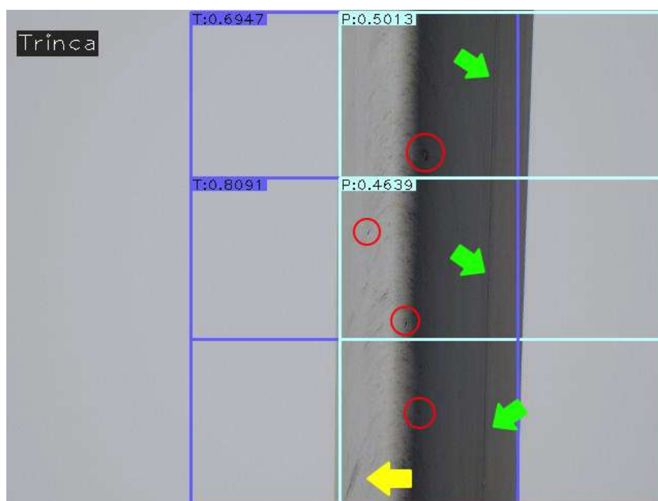
Figura 39 – Imagem original de pintura classificada incorretamente como dano de trinca. Com círculos vermelhos indicando os danos de pintura e setas verdes e amarelas indicando as características que influenciam a classificação como trinca
