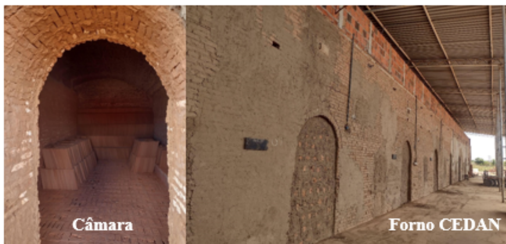
Figura 18 — Processo de queima através de forno CEDAN
