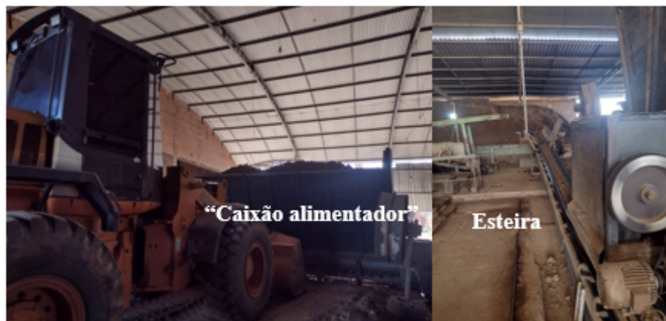
Figura 13 — Entrada da matéria-prima no processo de fabricação
