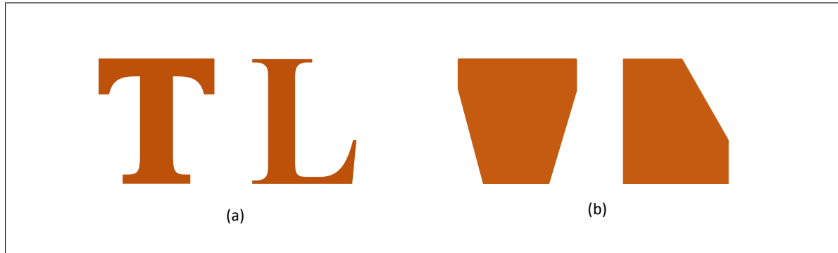
Figura 18 – Representação da operação de convex hull em uma região côncava. (a) caracteres côncavos; (b) o menor conjunto convexo contendo cada caractere definindo o convex hull
