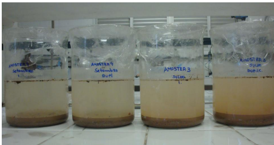
Figura 16– Amostras em repouso para preparação do extrato solubilizado dos RCC de Fortaleza-CE
