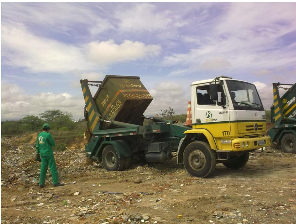
ANEXO A – Caminhão fazendo o descarregamento de RCC em Fortaleza-CE
