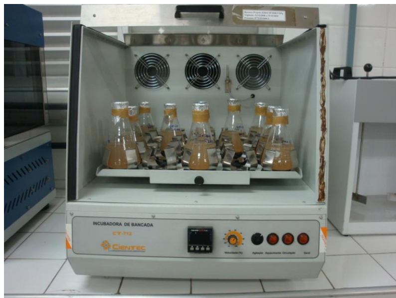
Figura 15 – Incubadora de agitação orbital contendo as amostras em agitação para preparação do extrato lixiviado.
