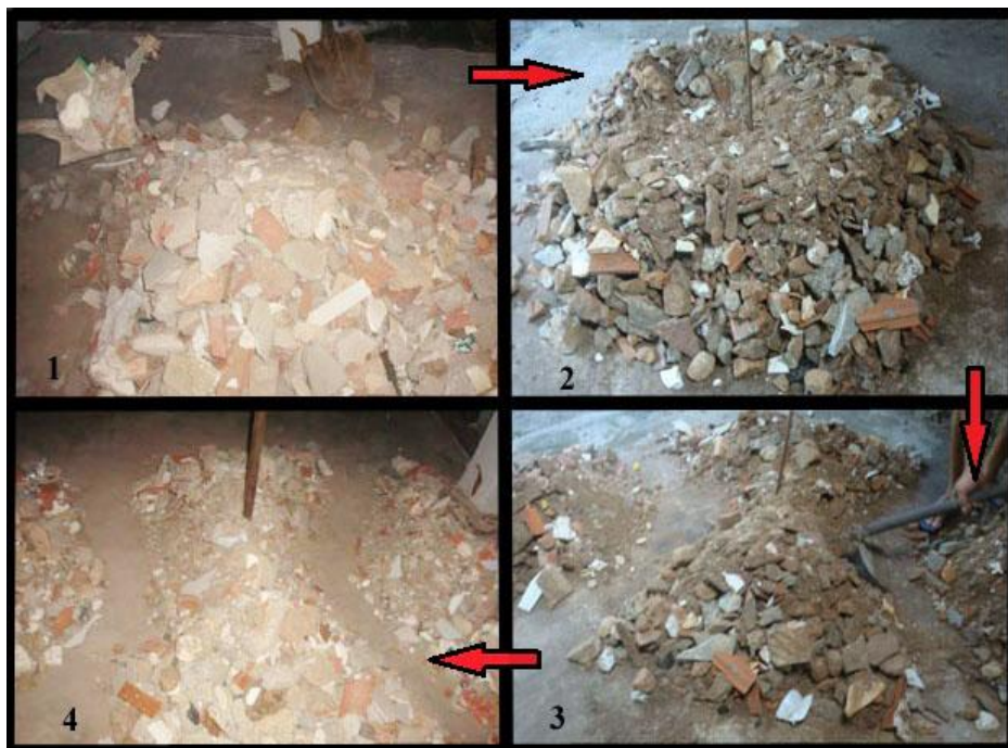
Figura 11 – Sequência de homogeneização e quarteamento da pilha de resíduos de construção civil.
