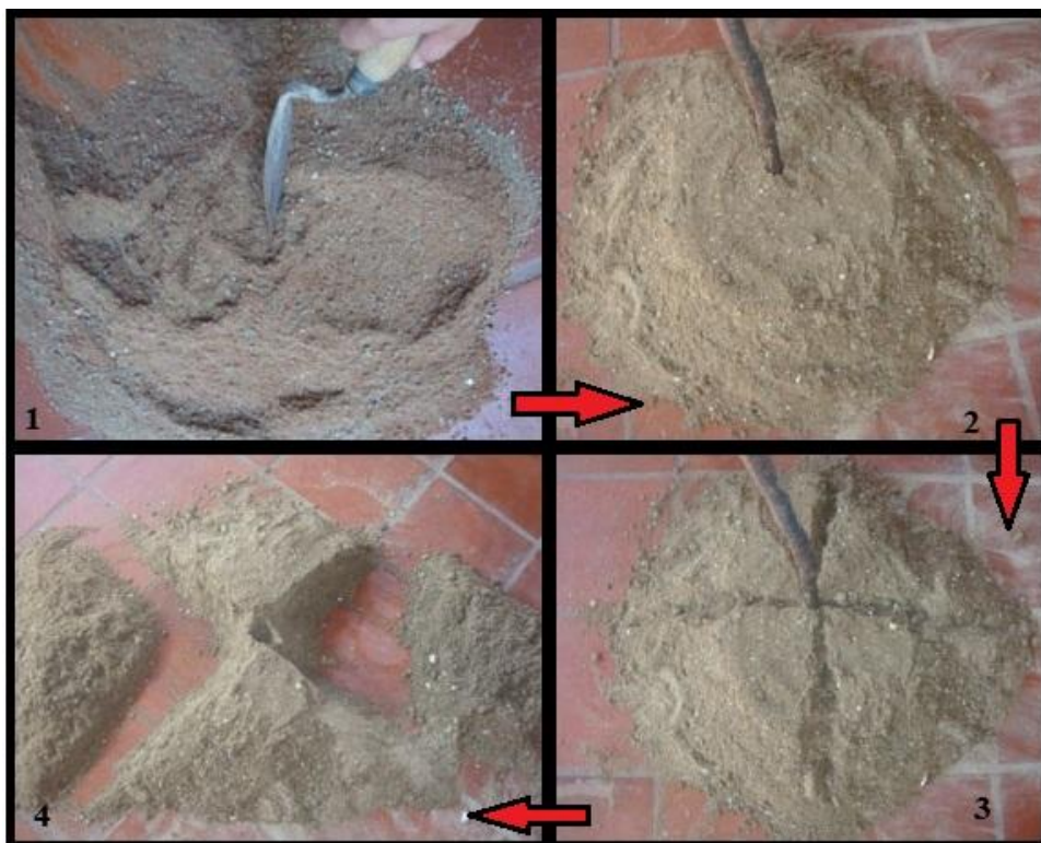
Figura 14 – Sequência de homogeneização e quarteamento da amostra de resíduo Classe A.
