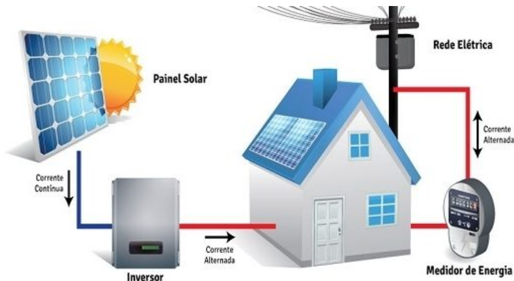
Figura 5 – Componentes de um sistema fotovoltaico
