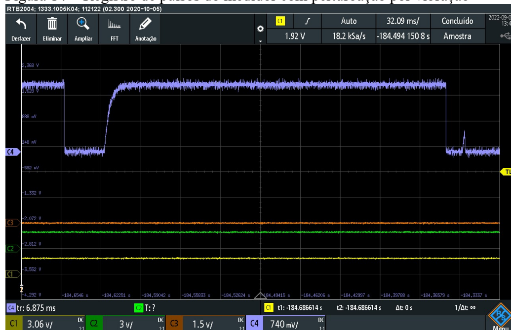
Figura 14 - Registro de pulsos do medidor com perturbação por vibração
