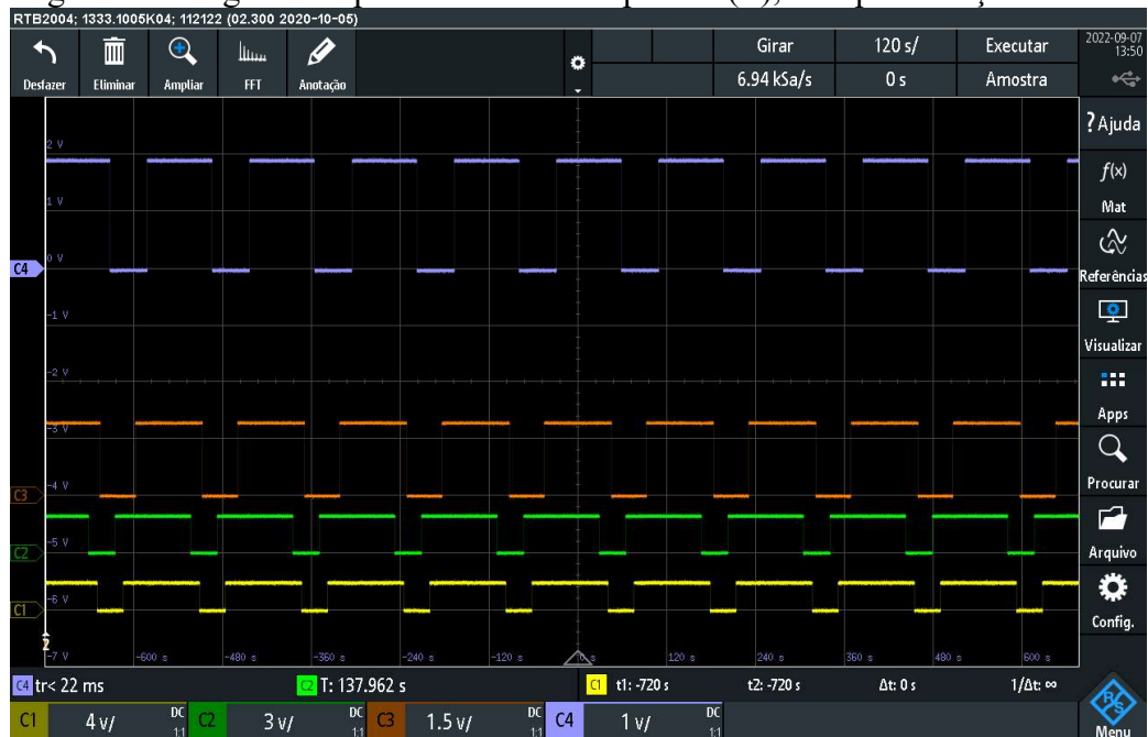
Figura 11 - Registro de pulsos do medidor padrão (Z), sem perturbação
