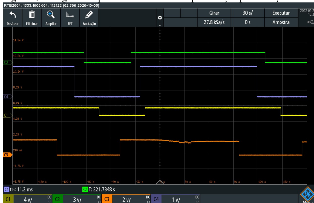
Figura 15 - Registro de pulsos do medidor com perturbação por vibração
