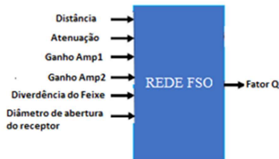
Figura 24 - Representação esquemática das entradas e saídas na simulação do canal FSO
