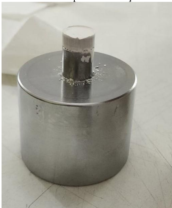
Figura 15 — Peça cerâmica de LNO prensada em formato cilíndrico, correspondente ao elemento ressoador da antena dielétrica, recém-retirada do molde metálico após conformação uniaxial.
