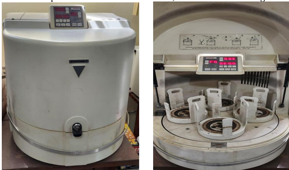
Figura 10 — Moinho planetário Fritsch Pulverisette 5, com a câmara de moagem aberta.
