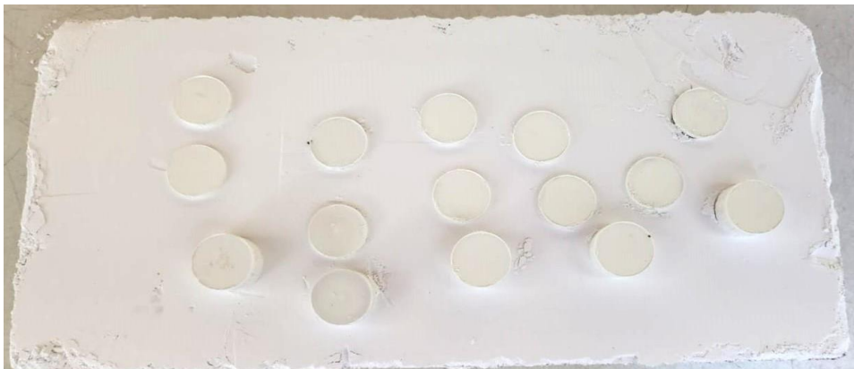
Figura 16 — Amostras cerâmicas cilíndricas (antenas dielétricas) após o processo de sinterização.
