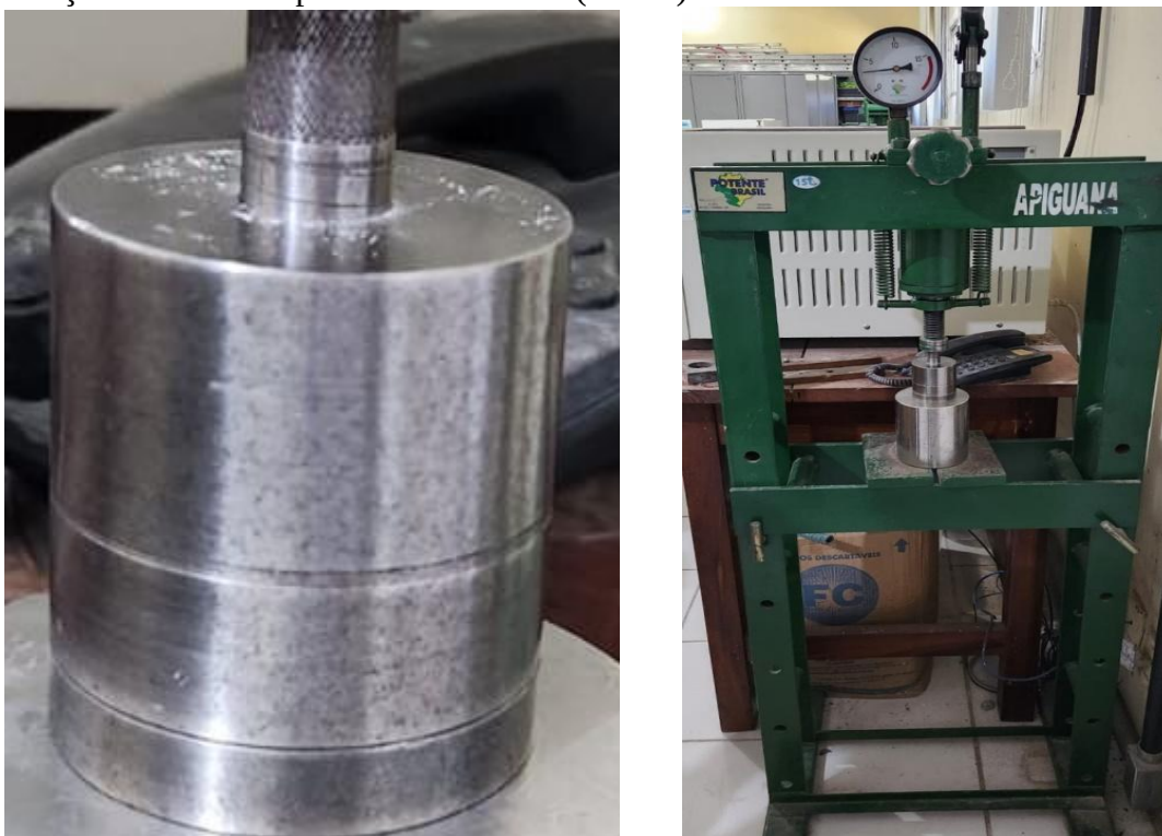
Figura 14 — Molde metálico cilíndrico utilizado para prensagem uniaxial das amostras cerâmicas em pastilhas (esquerda). Prensa hidráulica da marca Apiguana utilizada na conformação uniaxial das pastilhas cerâmicas (direita).
