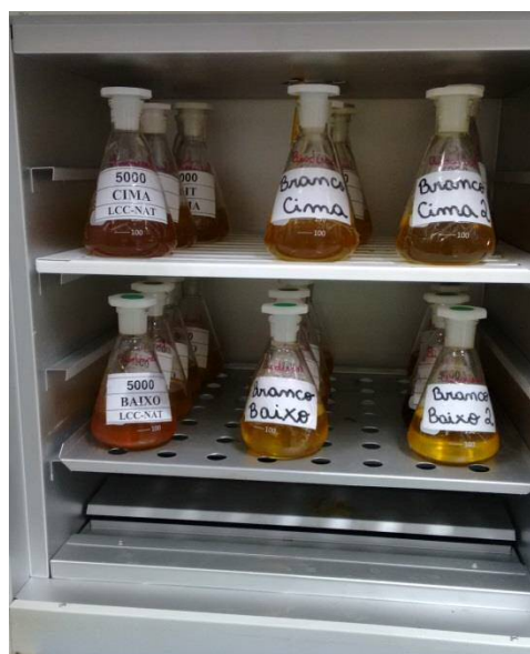
Figura 24 – Organização das amostras na estufa de secagem.
