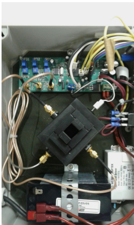
Figura 3.2-11 - Imagem interna do protótipo de bancada. Sensor óptico interligado ao sistema de controle. Fonte: Do próprio autor.
