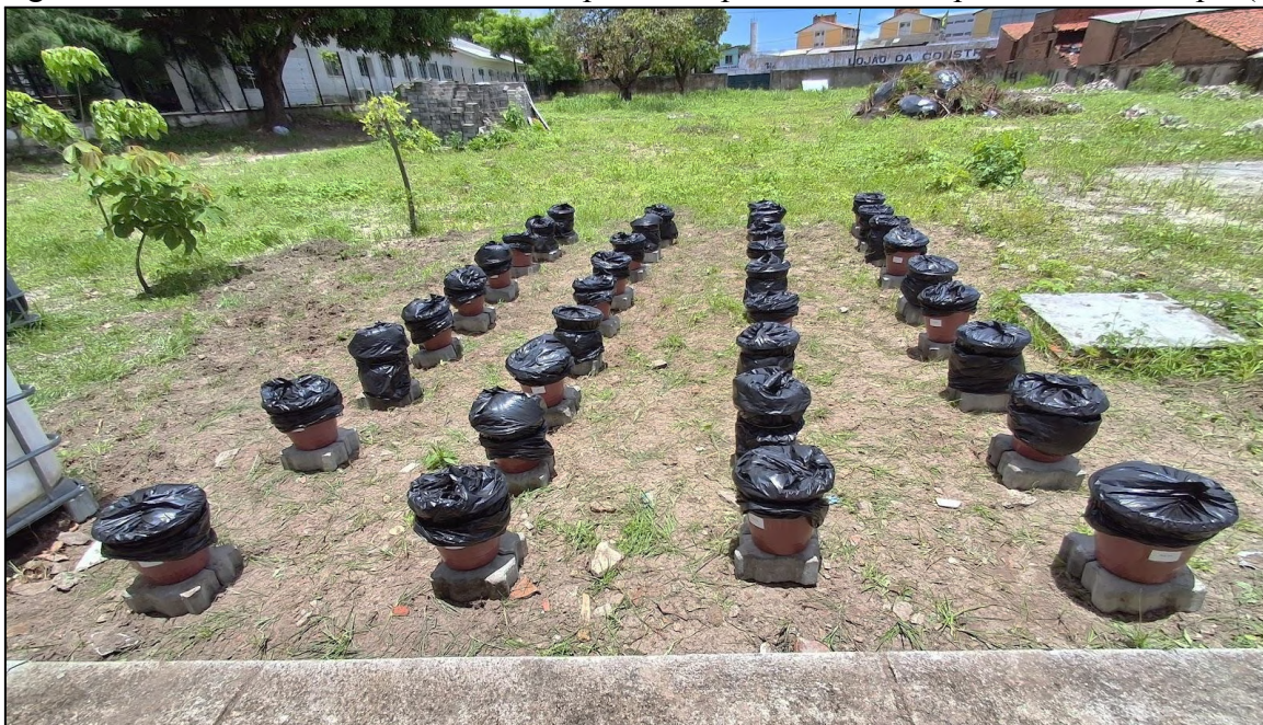
Figura 6 — Vasos vedados com sacos plásticos para teste da capacidade de campo (CC).
