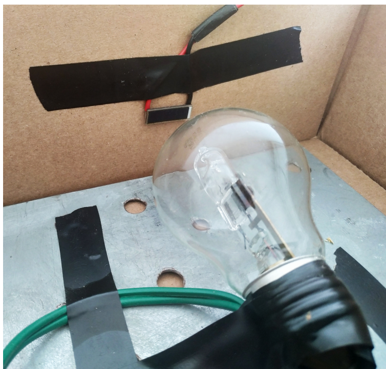
Figura 20 – Caixa de luz utilizada nos ensaios. Fonte: Autor.
