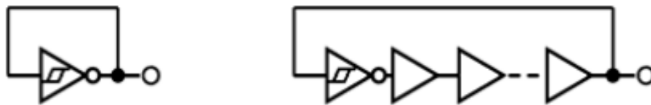
Figura 3.2 – Dois tipos de FROs, a esquerda um de alta velocidade e a direita um de baixa velocidade. A frequência é determinada pelos delays internos e capacitâncias esporádicas [40].
