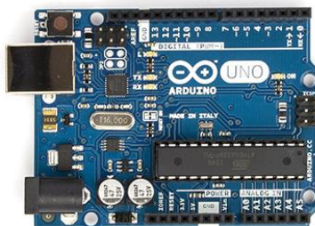
Figura 2.15 – Plataforma de Desenvolvimento Arduíno UNO Revisão 3.
