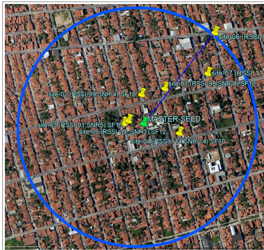
Figura 31 – Locações dos dispositivos para os testes em Fortaleza/CE. Fonte: Autor.
